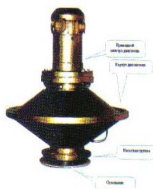
Рис.3.4.5. Инерциоид С. М. Полякова [22]. В качестве рабочего тела вращения использовалась ртуть, которая под действием насоса двигалась по спиральному трубопроводу. Когда движение ртути происходило с ускорением, потеря веса установки достигала 4 кг
